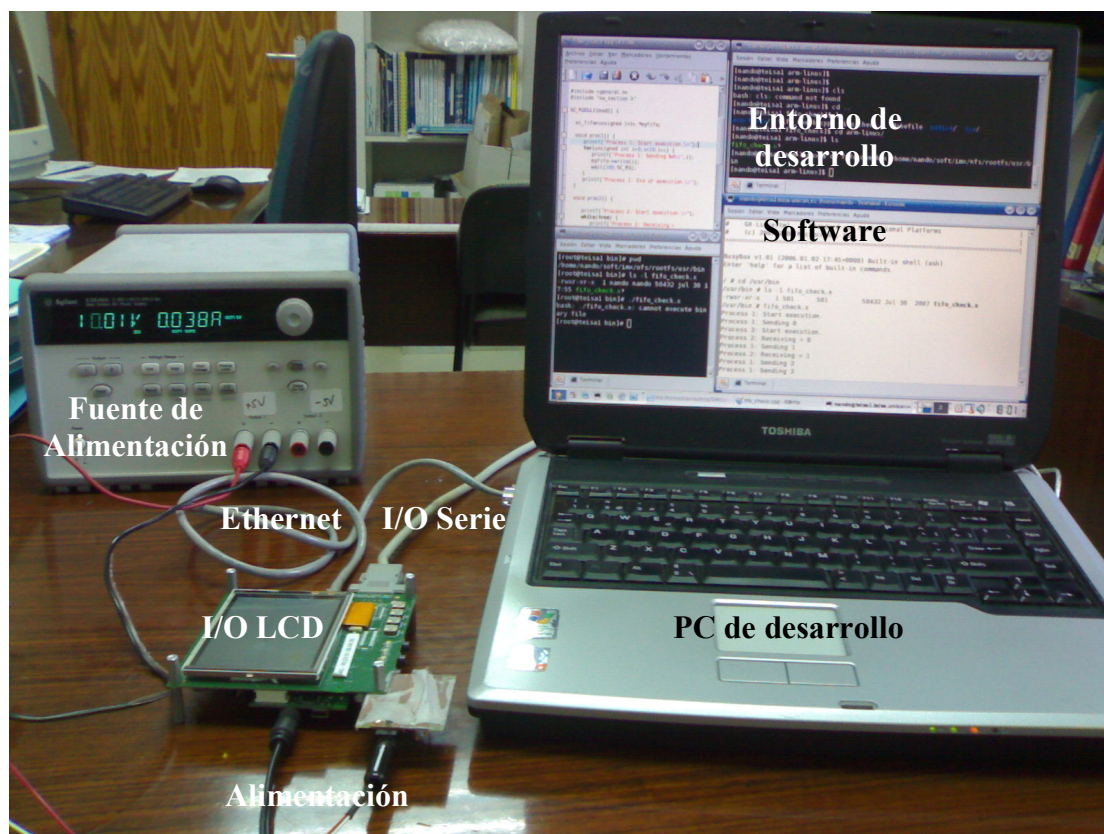
Figura 4-7. Conexión de la plataforma de Freescale con la plataforma de desarrollo.
